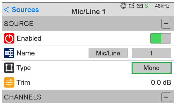
7. 画面にタッチして少しスクロールさせ、"CHANNELS" を表示させ、"Patch" の下のボックスを [Combo 1/2\_1] に設定します。
