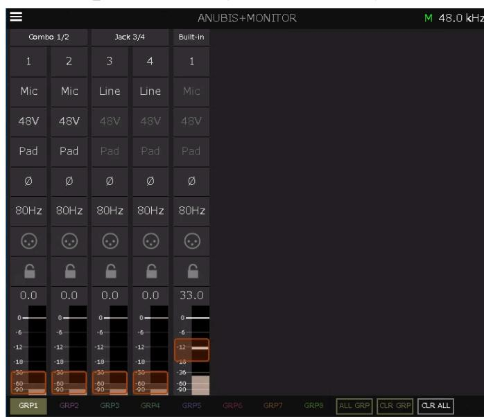
15.9. 再度、モニターGUIを表示させるには、"三"マークをクリックし、メニューから "Hide Preamps" をクリックします。
