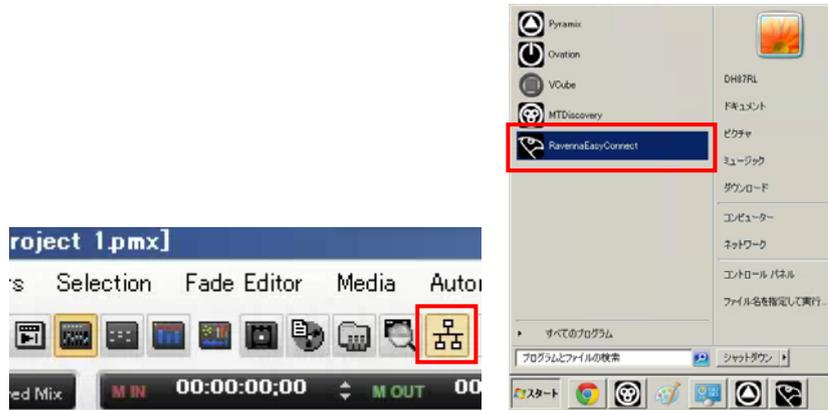
このインターフェースでは、Ravenna 上に出された Horus の入出力と、Pyramix の入出力が接続(Connect)されているかが確認できます。
