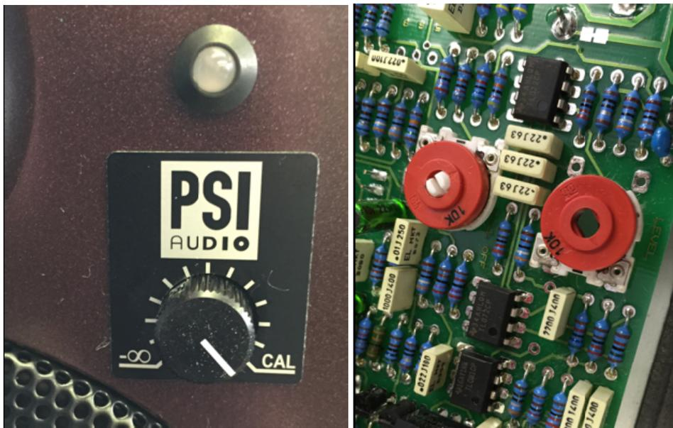
バックパネルをキャビネットに取り付ける際には、レベル用の軸をポテンシオメーターに合わせることに細心の注意を払ってください。これは非常に難しいので、バックパネルのレベルの穴からライトを使って軸を確認するのが最良の方法です。
